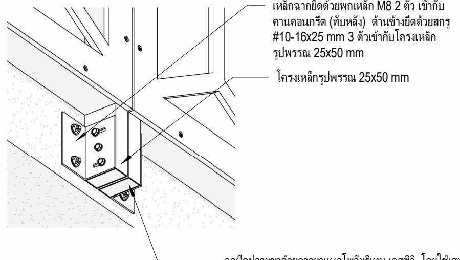
C1-3D Detail ยึดเหล็กฉาก มาตรฐาน
