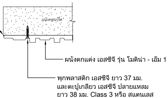
Detail จบงานด้านข้าง กรณีไม่ชนขอบคอนกรีต
